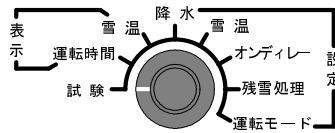
③ 一旦、デジタル表示が消灯し、現在の雪温センサーの検知温度を2秒間表示します。
