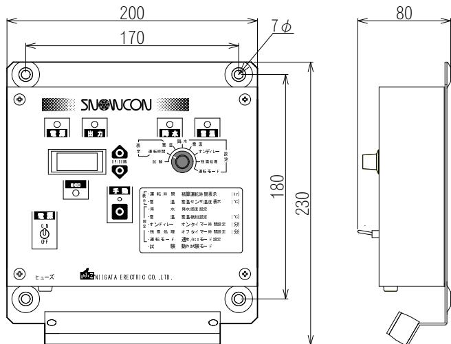
※ 従来型のスノーコンと取り替える場合は、専用取付金具 HK-1 を使用することで取付け穴を開けることなく取付けることができます。
