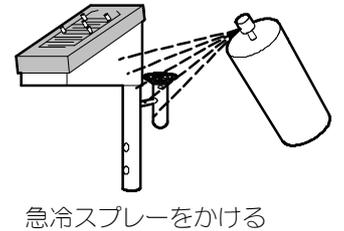
※ 検知温度が $-13^{\circ}\text{C}$ 以下まで下がると、**雪温ランプ**が点滅します。
