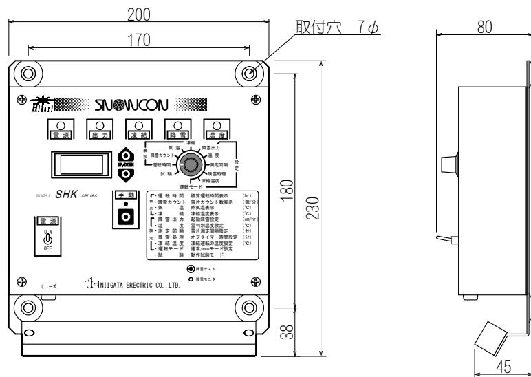
\* 従来型のスノーコンと取り替える場合は、専用取付金具 HK-1 を使用することで取付け穴を開けることなく取付ることができます。
